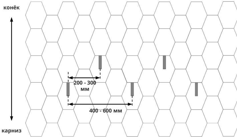
Снегозадержатель для гибкой черепицы необходимо механически фиксировать к основанию кровли через подкладочный ковер гвоздями или саморезами.
